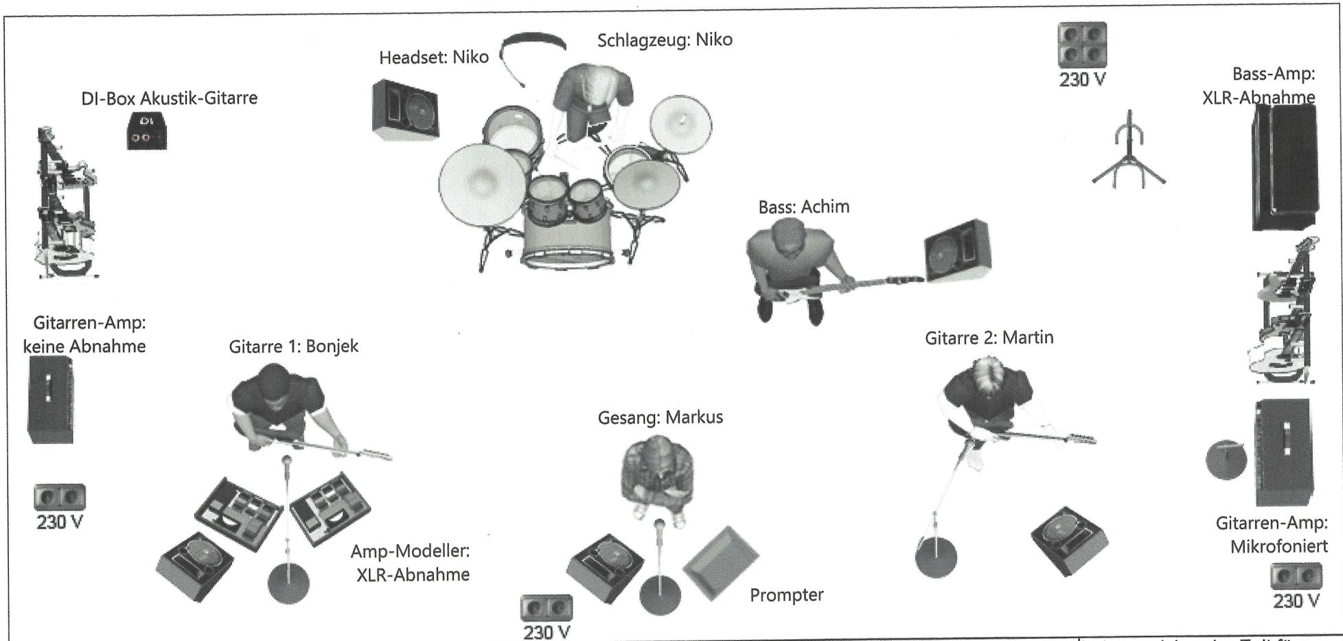
1. Schlagzeug (Niko) wird komplett mikrofoniert, mit sämtlicher Hardware (Mikrohalterungen) bis zur Stagebox verkabelt gestellt. Minimale Kanalbelegung: 5 (BD, Snare, 2 x OH, Sequencer)
