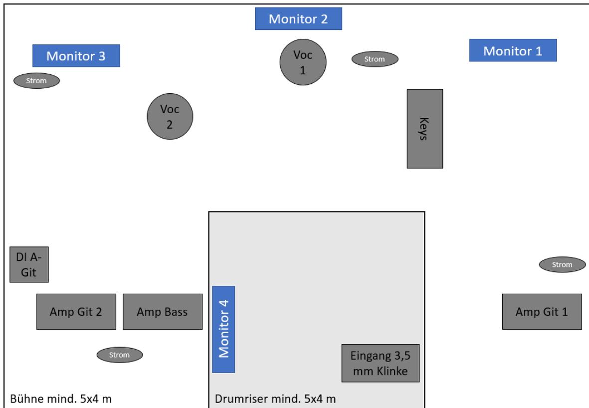
Insofern technisch möglich und ein ausreichend langer Slot für den Soundcheck gewährleistet werden kann, arbeiten wir sehr gern mit einem In-Ear-Monitoring System. Das dafür notwendige Equipment wird von uns mitgebracht. Die Monitore 2, 3 und 4 sind in diesem Fall nicht notwendig. Stattdessen benötigen 4 XLR-Ausgänge an Mischpult oder Stagebox sowie entsprechende Stromversorgung.
